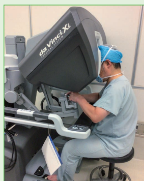
術者は「サージョンコンソール」とよばれる操縦席に座り、3D画像を見ながら手元のコントローラーを操作します。
